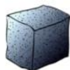
1 m 3 de béton environ 2 tonnes
